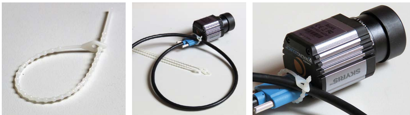
Abb. 01: wieder zu öffnender Kabelbinder (Knotenband). Abb. 02 und 03: Kabelschleufe direkt am USB 3.0 Stecker einer SkyRIS Kamera mit Knotenband zur Sicherung
